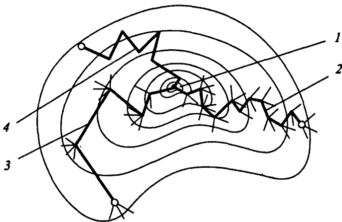
Рис.19. Иллюстрация траекторий поиска оптимума функции методами случайного поиска: 1 — область оптимума; 2 — траектория метода случайных направлений; 3 — траектория метода с наказанием случайностью; 4 — траектория метода блуждающего поиска; 5 — начальные точки поиска
