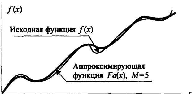
Рис. 3. Влияние степени аппроксимирующего полинома M на точность аппроксимации: a — M=2 , б — M=3 , в — M=5 .
